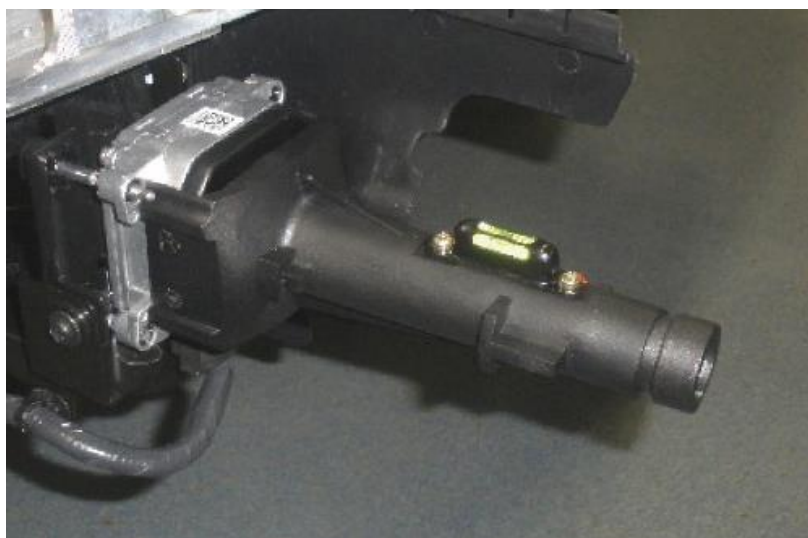
Przyrząd do kalibracji radaru (Zdjęcie: Nissan)
